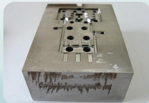
ガス焼けによる入子の腐食（55000 ショット後）
